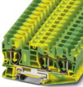
Schutzleiter-Reihenklemme, Anschlussart: Zugfederanschluss, Querschnitt: 0,2 mm 2 - 16 mm 2 , AWG: 24 - 6, Breite: 10,2 mm, Farbe: grün-gelb, Montageart: NS 35/7,5, NS 35/15
