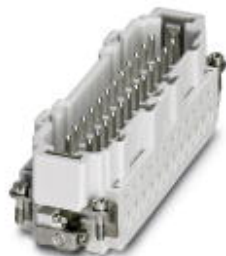
HEAVYCON Stifteinsatz, Serie B24, 24-polig, Schraubanschluss. PE-Anschluss mittels Zughülstechnik.
