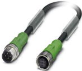
Sensor-/Aktor-Kabel, 4-polig, PUR, schwarzgrau RAL 7021, Stecker gerade M12, A-kodiert, auf Buchse gerade M12, A-kodiert, Kabellänge: 0,3 m
