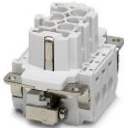
HEAVYCON Buchseneinsatz, Serie B6, 6 polig, Schraubanschluss. PE-Anschluss mittels Zughülstechnik.
