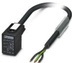
Sensor-/Aktor-Kabel, 3-polig, PUR halogenfrei, schwarzgrau RAL 7021, freies Leitungsende, auf Ventilstecker BI (11 mm), mit 1 LED, beschaltet mit Z-Diode, Kabellänge: 5 m
