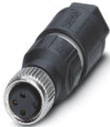
Sensor-/Aktor-Steckverbinder, 3-polig, Buchse gerade M8, A-kodiert, Schneidklemmanschluss, Rändelmaterial: Zinkdruckguss, vernickelt, Kabelaußendurchmesser 2,5 mm ... 5 mm
