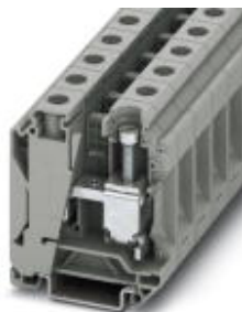
Durchgangsklemme, Anschlussart: Schraubanschluss, Belastungsstrom: 125 A, Querschnitt: 10 mm 2 - 35 mm 2 , AWG 8 - 2, Breite: 15,1 mm, Farbe: grau
