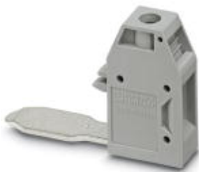
Abgriffklemme, Anschlussart: Spezial- und Mischanschluss, Querschnitt: 0,5 mm 2 - 10 mm 2 , AWG: 20 - 8, Breite: 10,2 mm, Höhe: 34,7 mm, Farbe: grau, Montageart: auf Basiselement
