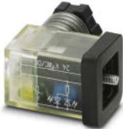
Ventilstecker, 3-polig, Bauform C, 1 LED, mit Schutzbeschaltung, Schraubanschluss, Kabelverschraubung M12
