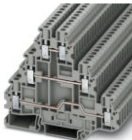
Mehrstock-Klemme, Querschnitt: 0,14 mm 2 - 4 mm 2 , AWG: 26 - 12, Anschlussart: Schraubanschluss, Breite: 5,2 mm, Farbe: grau, Montageart: NS 35/7,5, NS 35/15
