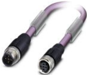
Bussystem-Kabel, CANopen®, DeviceNet™, CANopen®/DeviceNet™, 5-polig, PUR halogenfrei, violett RAL 4001, geschirmt, Stecker gerade M12, A-kodiert, auf Buchse gerade M12, A-kodiert, Kabellänge: 6 m
