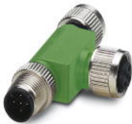
T-Verteiler, CANopen ® , DeviceNet ™ , CANopen ® /DeviceNet ™ , 5-polig, Stecker gerade M12, A-kodiert, auf Buchse gerade M12, A-kodiert und Buchse gerade M12, A-kodiert
