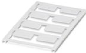
Einrastschildchen, Matte, weiß, unbeschriftet, beschriftbar mit: BLUEMARK CLED, BLUEMARK LED, Plotter, Montageart: Verrasten in Schildchenträger, Schriftfeldgröße: 27 x 12,5 mm
