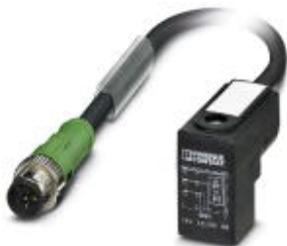
Sensor-/Aktor-Kabel, 3-polig, PUR, schwarz RAL 9005, Stecker gerade M12, A-kodiert, auf Ventilstecker C (8 mm), mit 1 LED, beschaltet mit Z-Diode, Kabellänge: 1,5 m
