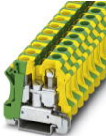
Installationsschutzleiterklemme, Spezial- und Mischanschluss, Querschnitt: 6 mm 2 - 25 mm 2 , AWG: 10 - 4, Breite: 12,2 mm, Farbe: grün-gelb, Montageart: NS 35/7,5, NS 35/15
