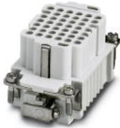
HEAVYCON Buchseneinsatz, Serie DD42, 42 polig, Crimpanschluss. PE-Anschluss mittels Zughülstechnik.
