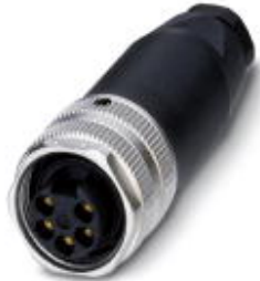
Sensor-/Aktor-Stecker, Buchse, gerade, 5-polig, 7/8", Schraubanschluss, Metallrändel, Kabelverschraubung Pg9
