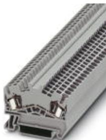
Durchgangsklemme, Anschlussart: Zugfederanschluss, Querschnitt: 0,08 mm<sup>2</sup> - 4 mm<sup>2</sup>, AWG: 28 - 12, Breite: 5,2 mm, Farbe: grau, Montageart: NS 35/7,5, NS 35/15
