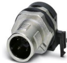
Sensor-/Aktor-Einbausteckverbinder, Stecker, 4-polig, M12-SPEEDCON, A-kodiert, geschirmt, Hinterwand-/Schraubmontage mit M12 Gewinde, verdrehgeschützt, mit gewinkeltem Lötanschluss
