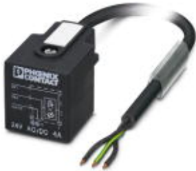
Sensor-/Aktor-Kabel, 3-polig, PUR halogenfrei, schwarzgrau RAL 7021, freies Leitungsende, auf Ventilstecker A, mit 1 LED, beschaltet mit Varistor, Kabellänge: 1,5 m
