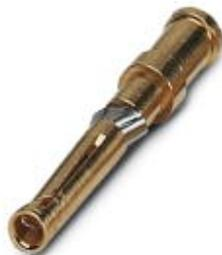
Gedrehter 1,6er Crimpkontakt, Buchsen-Einzelkontakt, Aderquerschnitt 1,5 mm<sup>2</sup>, vergoldet
