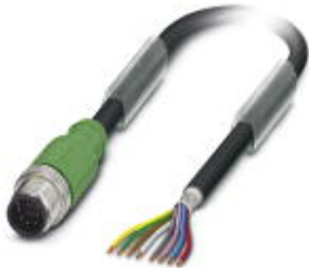
Sensor-/Aktor-Kabel, 8-polig, PUR halogenfrei, schwarzgrau RAL 7021, geschirmt, Stecker gerade M12, A-kodiert, auf freies Leitungsende, Kabellänge: 1,5 m
