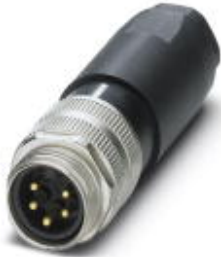
Sensor-/Aktor-Stecker, Stecker, gerade, 5-polig, 7/8", Schraubanschluss, Metallrändel, Kabelverschraubung Pg13
