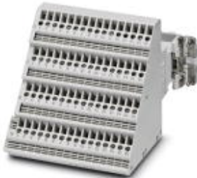
HEAVYCON Klemmenadapter Buchseneinsatz, Serie D64, 64-polig, Schutzleiteranschluss links für die rechte Schaltschrankseite, Schraubanschluss
