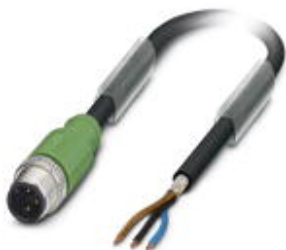
Sensor-/Aktor-Kabel, 3-polig, PUR halogenfrei, schwarzgrau RAL 7021, geschirmt, Stecker gerade M12, A-kodiert, auf freies Leitungsende, Kabellänge: 1,5 m
