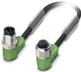
Sensor-/Aktor-Kabel, 4-polig, PUR halogenfrei, schwarzgrau RAL 7021, Stecker gewinkelt M12, A-kodiert, auf Buchse gewinkelt M12, A-kodiert, Kabellänge: 1,5 m
