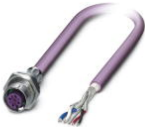
Bus-System-Einbaubuchse, DeviceNet/CANopen, 5-polig, M12, geschirmt, A-kodiert, SPEEDCON, Hinterwand-/Schraubmontage mit Pg9-Gewinde, mit 2,0 m Buskabel, 2 x 0,2 mm 2 ; 2 x 0,32 mm 2
