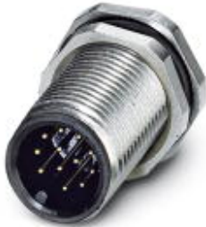
Sensor-/Aktor-Einbaustecker, 12-polig, M12, Hinterwand-/Schraubmontage mit M12 Gewinde, mit geradem Lötanschluss
