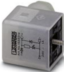
Ventilstecker, 3-polig, Bauform A, 1 LED, mit Schutzbeschaltung, Schraubanschluss, Kabelverschraubung Pg9
