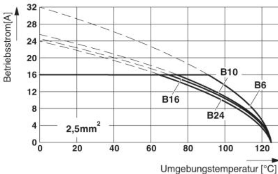
Abbildung zeigt das Derating-Diagramm verschiedener Kontakteinsätze Serie B (B6 bis B24), Leiterquerschnitt 2,5 mm<sup>2</sup>
