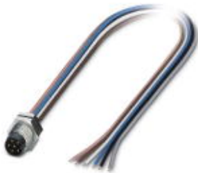
Sensor-/Aktor-Einbaustecker, 6-polig, M8, Hinterwand-/Schraubmontage mit M8-Gewinde, mit 0,5 m TPE-Litze, 6 x 0,14 mm 2
