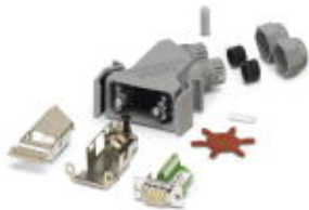
D-SUB Komplettsteckverbinder, für INTERBUS, Shell-Größe 1, Stift, Schraubanschluss, geschirmt, Anschlussrichtung gerade, Schutzart IP67
