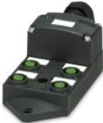
Sensor-/Aktor-Box, Anschlussart: M12-SPEEDCON-Buchse Kunststoff, Anzahl der Steckplätze: 4, Polzahl: 5, Steckplatzbelegung: doppelt, Statusanzeige: Nein, Universal; Stammleitungsanschluss: Steckbarer Schraubanschluss 180°, Schirmung: nein
