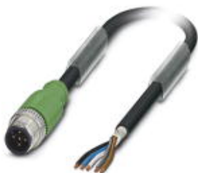
Sensor-/Aktor-Kabel, 5-polig, PUR halogenfrei, schwarzgrau RAL 7021, geschirmt, Stecker gerade M12, A-kodiert, auf freies Leitungsende, Kabellänge: 1,5 m
