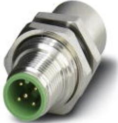
Sensor-/Aktor-Schalterschrankdurchführung, Stecker auf Buchse, 5-polig, M12, geschirmt, A-kodiert, Bipolare-/Schraubmontage mit M16 Gewinde
