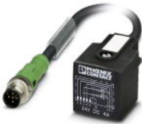
Sensor-/Aktor-Kabel, 5-polig, PUR halogenfrei, schwarz RAL 9005, Stecker gerade M12 SPEEDCON, A-kodiert, auf Ventilstecker AD (Druckschalter), mit 2 LEDs, Kabellänge: 1,5 m
