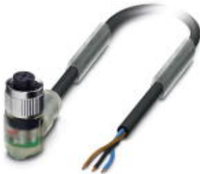
Sensor-/Aktor-Kabel, 3-polig, PUR halogenfrei, schwarzgrau RAL 7021, freies Leitungsende, auf Buchse gewinkelt M12, A-kodiert, mit 2 LEDs, PIN 2+4 gebrückt, Kabellänge: 10 m
