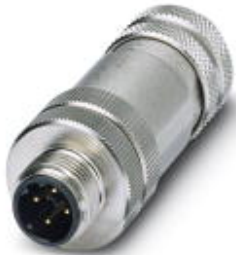
Bus-Systemsteckverbinder, Stecker, gerade, 4-polig, M12 geschirmt, D-kodiert, Schraubanschluss, Metallrändel, Kabelverschraubung Pg7
