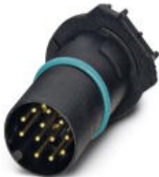
Sensor-/Aktor-Einbaustecker, 12-polig, A-kodiert, mit geradem THR-Lötanschluss, nur Kontakteinsatz
