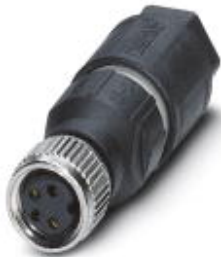
Sensor-/Aktor-Steckverbinder, 4-polig, Buchse gerade M8, A-kodiert, Schneidklemmanschluss, Rändelmaterial: Zinkdruckguss, vernickelt, Kabelaußendurchmesser 2,5 mm ... 5 mm
