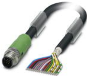
Sensor-/Aktor-Kabel, 17-polig, PUR/PVC, schwarz RAL 9005, geschirmt, Stecker gerade M12 SPEEDCON, A-kodiert, auf freies Leitungsende, Kabellänge: 5 m
