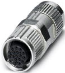
Sensor-/Aktor-Steckverbinder, Buchse, gerade, 17-polig, M12-SPEEDCON, Metallrändel, Piercecon®, Kabeldurchmesser max. 8,2 mm
