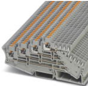
Mehrstock-Klemme, Anschlussart: Push-in-Anschluss, Querschnitt: 0,14 mm 2 - 4 mm 2 , AWG: 26 - 12, Breite: 5,2 mm, Farbe: grau, Montageart: NS 35/7,5, NS 35/15
