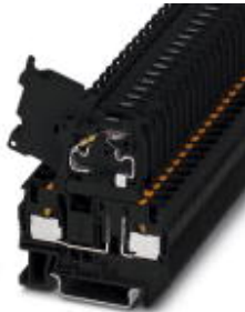
Hebel-Sicherungsklemme, Farbe schwarz, für 5 x 20 mm G-Sicherungseinsätze, mit Leuchtanzeige für 250 V AC
