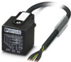
Sensor-/Aktor-Kabel, 5-polig, PUR halogenfrei, schwarz RAL 9005, freies Leitungsende, auf Ventilstecker AD (Druckschalter), mit 2 LEDs, Kabellänge: 5 m
