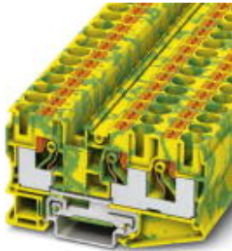
Schutzleiter-Reihenklemme, Anschlussart: Push-in-Anschluss, Querschnitt: 0,5 mm 2 - 16 mm 2 , AWG: 20 - 6, Breite: 10,2 mm, Höhe: 49,5 mm, Farbe: grün-gelb, Montageart: NS 35/7,5, NS 35/15
