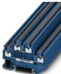
Doppelstock-Klemme, Querschnitt: 0,14 mm 2 - 1,5 mm 2 , AWG: 26 - 14, Anschlussart: Push-in-Anschluss, Breite: 3,5 mm, Farbe: blau, Montageart: NS 35/7,5, NS 35/15
