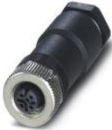
Steckverbinder, Universal, 4-polig, Buchse gerade M12, A-kodiert, Schraubanschluss, Rändelmaterial: Zinkdruckguss, vernickelt, Kabelverschraubung Pg11, Kabelaußendurchmesser 8 mm ... 10 mm
