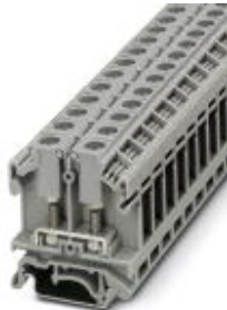
Universalklemme mit Bolzen-Anschluss, mit Prüfbuchsen-schrauben, Querschnitt: 0,1 - 6 mm 2 , Breite: 11 mm, Farbe: grau
