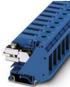
N-Trennklemme, Spezial- und Mischanschluss, Querschnitt: 0,75 mm 2 - 35 mm 2 , AWG: 18 - 2, Breite: 15 mm, Farbe: blau, Montageart: NS 35/7,5, NS 35/15
